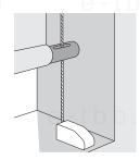
Guiado por cables de acero inoxidable de 2 mm. Posibilidad de anclaje lateral (entre paredes) o inferior.
