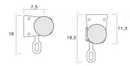
El mecanismo incluidos los soportes y el mando sobresale del tejido, según el sistema de accionamiento:
