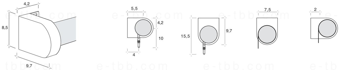
El mecanismo incluidos los soportes y el mando sobresale del tejido, según el sistema de accionamiento:
